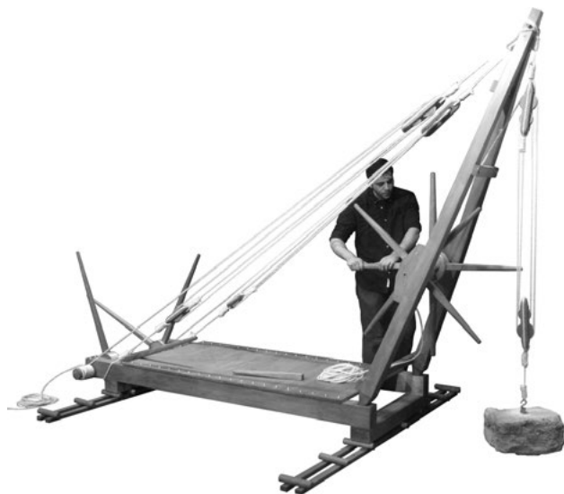
Ανυψωτική μηχανή με βαρούλκα ανύψωσης ιστού και φορτίου © Μουσείο Αρχαίας Ελληνικής Τεχνολογίας Κώστα Κοτσανά
